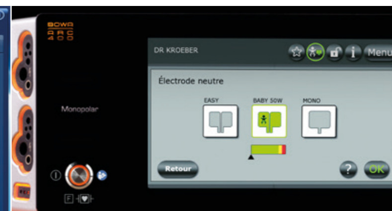
Tout dans la zone verte ? La surveillance de l'électrode neutre, ici dans le paramétrage pour bébés (max. 50 watts), vous informe sur le statut.
